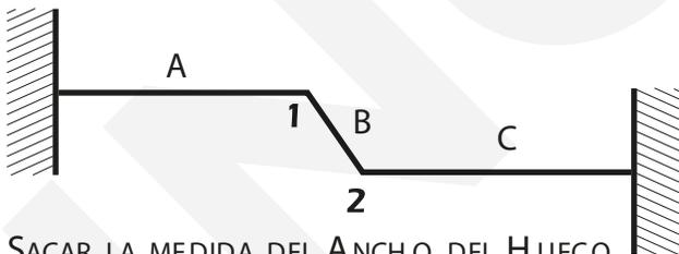
SACAR LA MEDIDA DEL ANCHO DEL HUECO ENTRE LAS EXTREMIDADES Y UTILIZAR COMO REFERENCIA PARA LA MEDICIÓN SIEMPRE EL LADO DE FUERA DEL PERFIL "U" DE REGLAJE.
